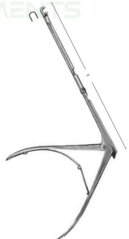
Hajek-Kofler Rongeur punch 14-436 X - 18 cm 3.5 mm Shaft rotates 360°
